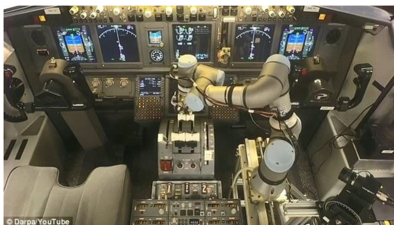
Obr. 3 Příklad realizace robota na místě druhého pilota (DARPA, 2019)
